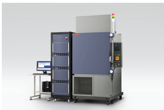
充放電装置 (SBT) とのシステム例
